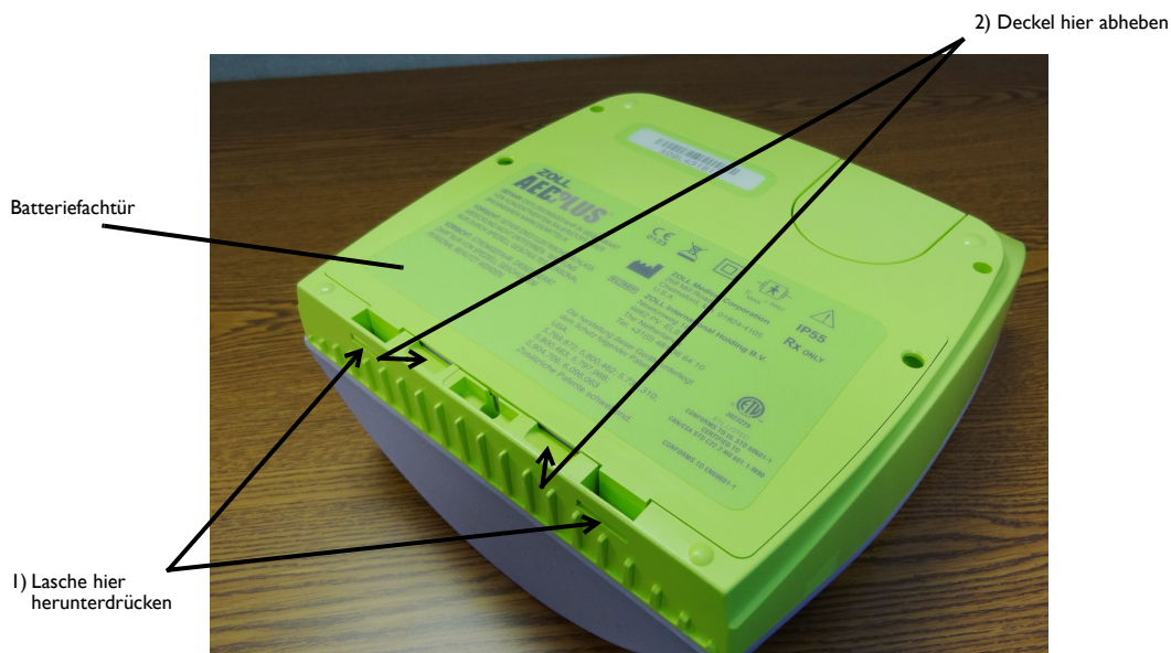
Abbildung 6: Batteriefachtür abnehmen
